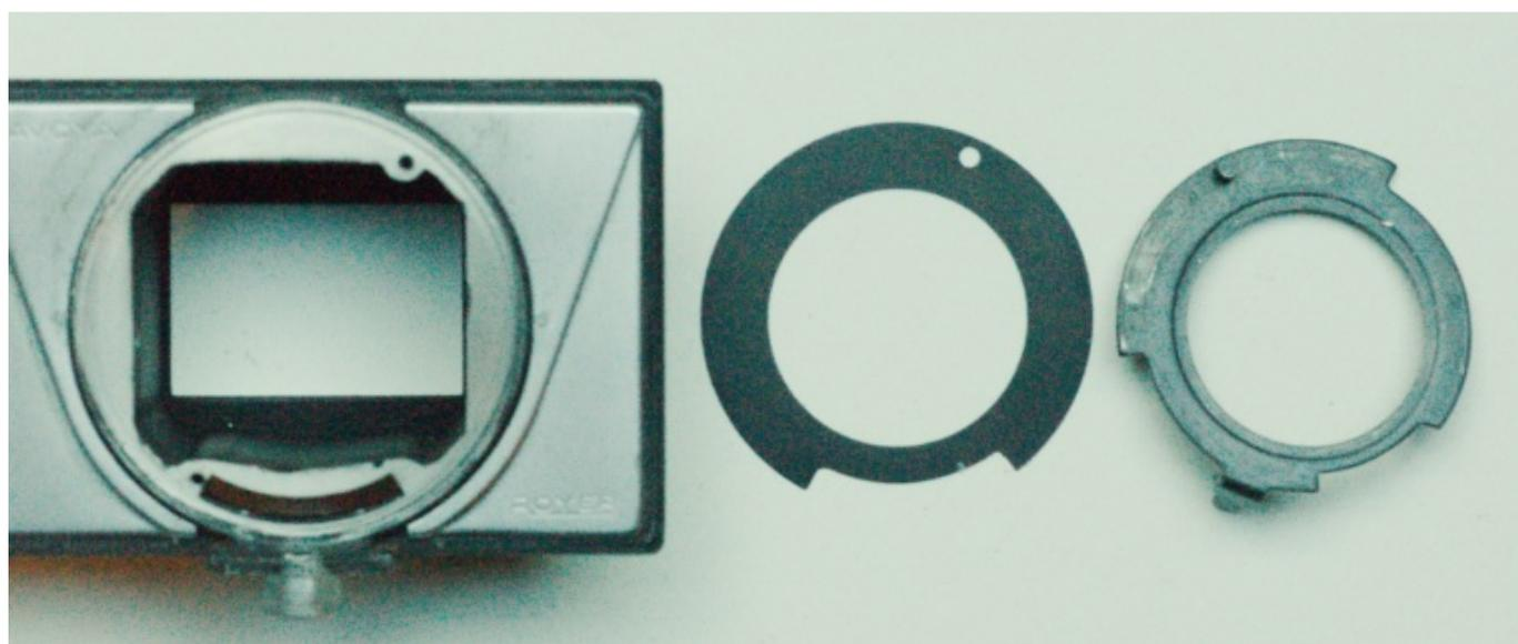
*Figure 6. Pièces de transmission pour l'armement de l'obturateur*
