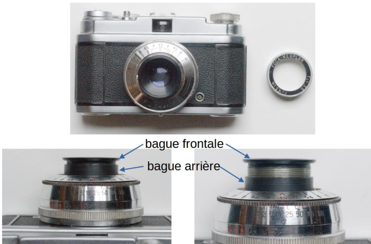
**Figure 3. Vue après démontage de la bague de mise au point**
